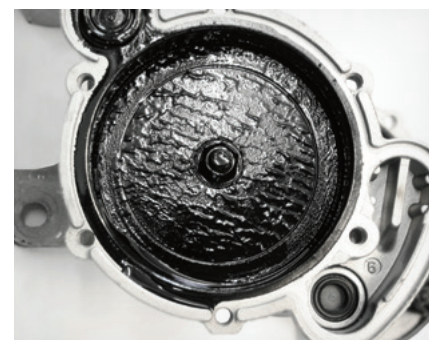
Abb. 3: Ölschlamm in der Vakuumpumpe vom VW Transporter führt zu Klappergeräuschen
